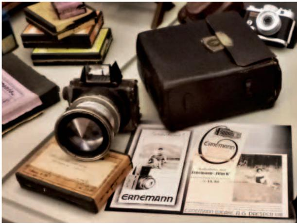
FIG. 4. La fotocamera Ernemann esposta al Museo della Specola dell'Università di Bologna. Sull'obiettivo *Ernostar f/2* è montata la lente conica progettata da Guido Horn d'Arturo. (Foto F. Bòboli)
