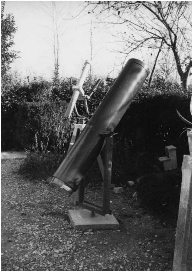
FIG. 2. Il primo telescopio newton da 22 cm, autocostruito con ottica di Virgilio Marcon.
