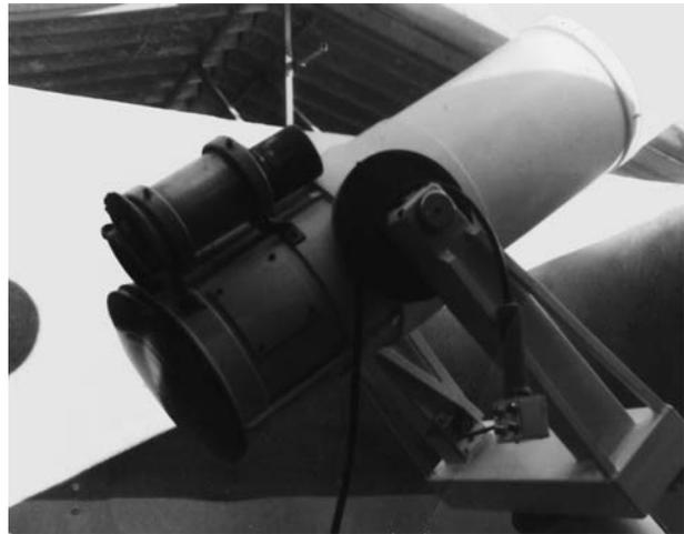
FIG. 3. Il secondo telescopio newton da 25 cm con montatura Conte, ottica Virgilio Marcon.
