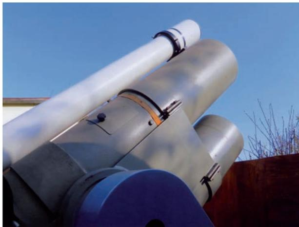
FIG. 4. Attuale configurazione realizzata dalle Officine Marcon, Schmidt e Newton in parallelo, entrambi da 25 cm di apertura, con rifrattore di guida.
