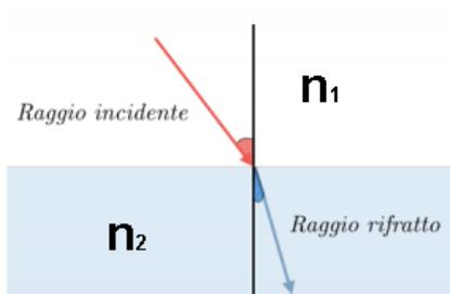
Il fenomeno della rifrazione ha origine dal cambiamento di velocità delle onde luminose quando passano da un mezzo trasparente all'altro. Esiste una proporzione tra le due diverse velocità e i seni degli angoli  $\theta_{\text{incidenza}}$  e  $\theta_{\text{rifrazione}}$  che i raggi formano con la linea normale alla superficie nel punto colpito dal raggio. Se consideriamo gli indici di rifrazione  $n_1$  e  $n_2$  dei materiali, la proporzione è inversa.
