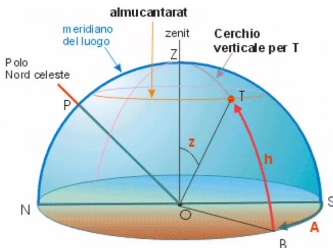
Nel sistema **altazimutale** o **orizzontale** la *direzione fondamentale* è data dalla verticale, il piano perpendicolare è dato dall'orizzonte astronomico la verticale alla superficie terrestre passante per l'osservatore individua lo zenit e il nadir. Le coordinate in questo sistema sono l'**Azimut (A)** e **Altezza (h)**.
