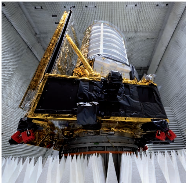
FIG. 1. Il satellite Euclid durante i test di compatibilità elettromagnetica condotti pochi mesi prima del lancio. Il satellite misura circa 4,7 m di altezza e 3,7 m di diametro. Nella parte superiore sono visibili il telescopio, dotato di uno specchio primario di 1,2 m di diametro, e il modulo di carico utile, che ospita gli strumenti scientifici VIS e NISP. Nella parte inferiore si trova il modulo di servizio, che contiene i sistemi necessari all'alimentazione, al controllo d'assetto, alle telecomunicazioni e alla gestione dei dati. La grande struttura laterale funge da schermo per la radiazione solare e da supporto per i pannelli fotovoltaici. (Crediti: ESA - Manuel Pedoussaut)
