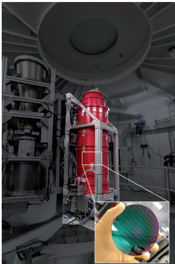
FIG. 2. MISTRAL installato nella camera gregoriana del Sardinia Radio Telescope. Nel riquadro, il wafer di MISTRAL prima di essere installato all'interno del criostato. (Crediti: G. Pettinari, CNR/IFN)
