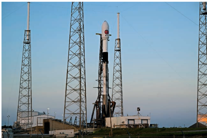
FIG. 5. Il razzo sulla rampa della Cape Canaveral Space Force Station , in Florida, poche ore prima del lancio. Il satellite Euclid è alloggiato nella parte superiore del razzo, all'interno della carenatura protettiva posta sopra il secondo stadio, che lo protegge durante l'attraversamento dell'atmosfera. Dopo il distacco della carenatura e la separazione dal secondo stadio, Euclid ha iniziato il viaggio verso il secondo punto lagrangiano del sistema Sole-Terra. (Crediti: ESA – S. Corvaja)
