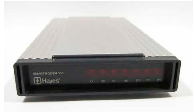
FIG. 3. Hayes-Smartmodem-300; il modem Hayes da 300 baudios di velocità, introdotto nel 1981, costituì un importante sviluppo nella tecnologia dei modem.
