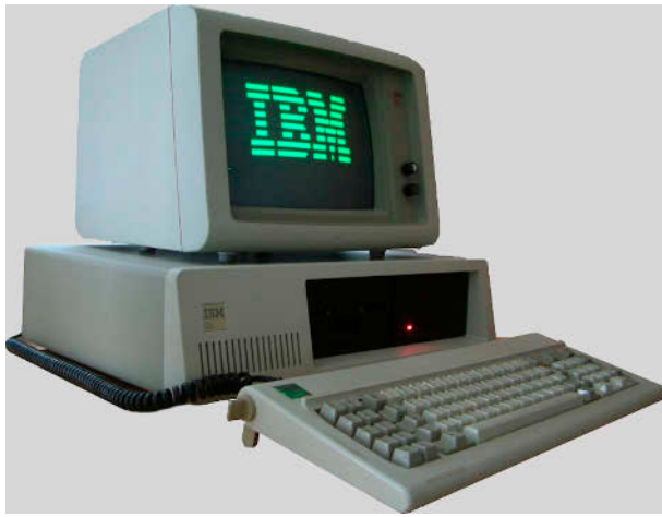
FIG. 2. Il computer IBM XT del 1983 (l'unità centrale è sprovvista di hard disk ).
