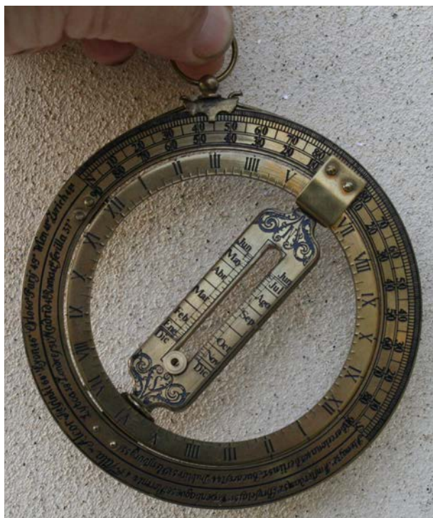
FIG. 5. Anello equinoziale universale.
